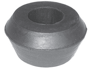
JC REI: 23140 | OR: 339.188 G 1.677.866 Descrição: Bucha Amortecedor Traseiro Aplicação: T-112/113/114 F-113 L-113 R-142/143 P-93/94 K-112/113 124 94H
